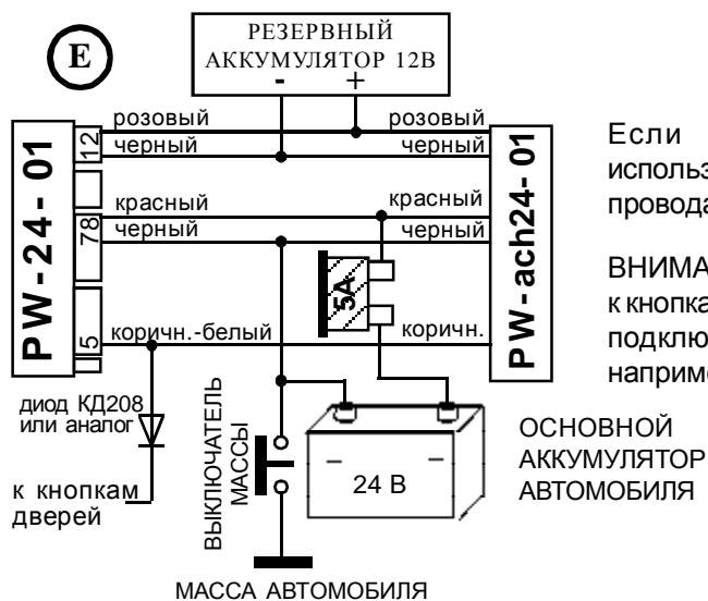
Рис.3. Подключение резервного аккумулятора и контроллера заряда PW-ach24-01.
