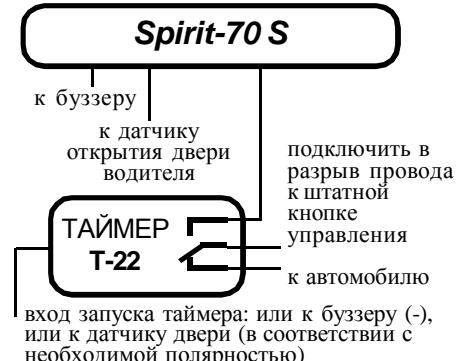
При таком способе подключения штатная кнопка отключается от автомобиля и переключается на вход иммобилайзера на время, заданное T-22, или после открытия двери, или после касания ЭК к ГС.
