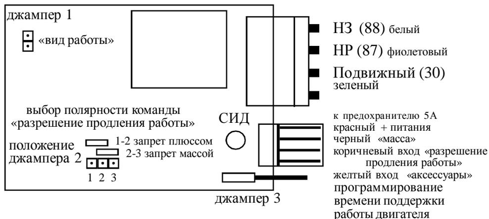
Перед установкой турбо-таймера на автомобиль необходимо провести настройку блока. Для этого необходимо снять крышку блока, для чего потянуть за козырек крышки (над разъемами) вверх (крышка фиксируется на двух защелках, расположенных на длинных сторонах блока), и произвести установку режимов:
