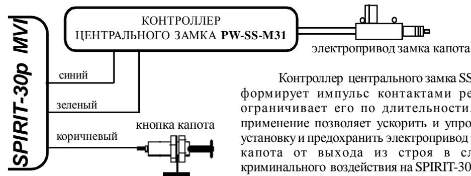
Контроллер центрального замка SS-M31 формирует импульс контактами реле и ограничивает его по длительности. Его применение позволяет ускорить и упростить установку и предохранить электропривод замка капота от выхода из строя в случае криминального воздействия на SPIRIT-30MVI.
