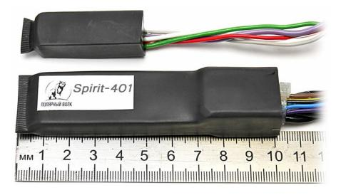
Такая конструкция позволяет гарантировать 100% работоспособность в подкапотном пространстве, не опасаясь влияния влаги и химических солей из окружающей среды. Надежность работы обеспечена при температурах от -40°C до +95°C, что шире, чем требования ГОСТ и стандартов международного автопрома!
